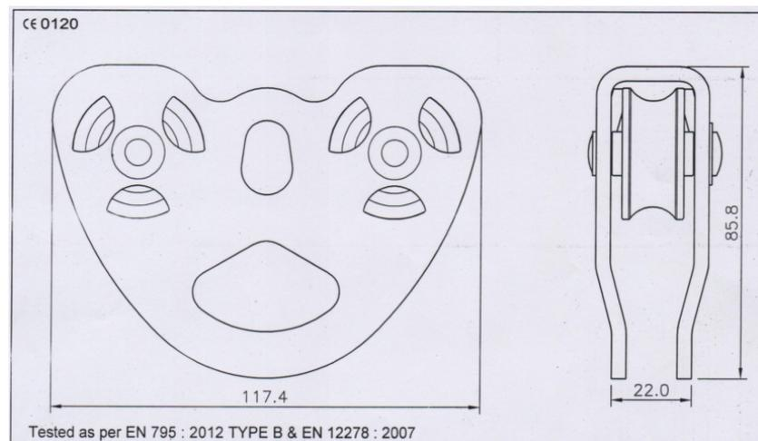
Polea tipo tandem con rodamientos.
