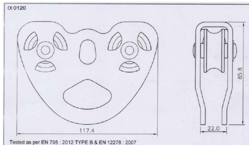
Polea tipo tandem con rodamientos.
