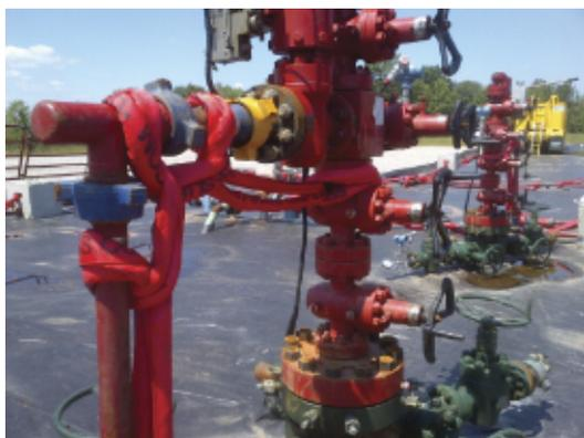
Cada eslinga de retención IZT posee su etiqueta identificatoria con las relaciones entre los diámetros de tuberías y las presiones máximas admisibles.
